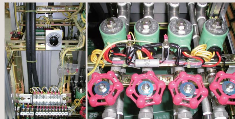
電磁弁を使った試験装置
